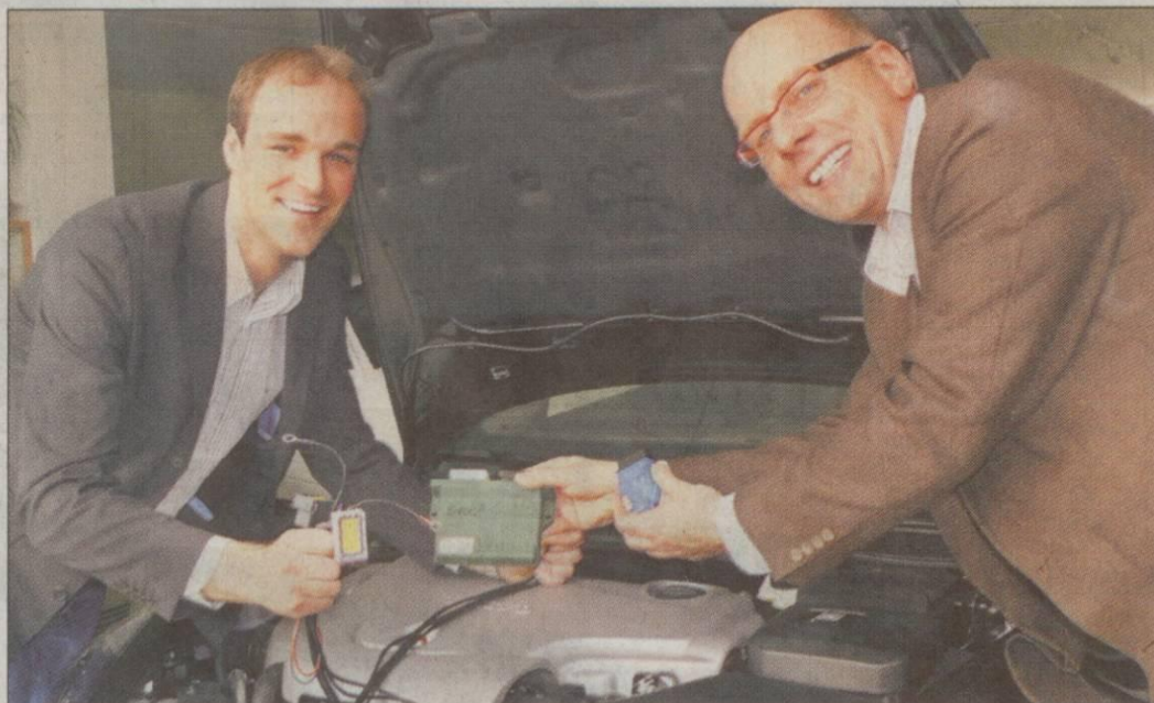
Volker Grosse und Heiko Lichtenberg zeigen den Umrüstsatz „t-ec2“ auf Bioethanol, der in nur zwei Stunden in das Auto eingebaut wird. Fotos: Mic
